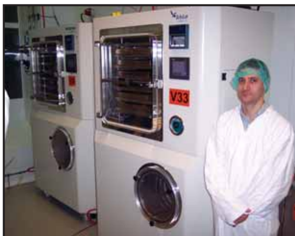
2. kép A LyoBeta-35 liofilizáló üzembe helyezése; háttérben a korábbi, hasonló berendezés
