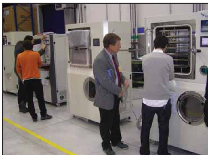
1. kép LyoBeta-35 liofilizáló berendezés gyártóművi átvétele; háttérben a másik, cikkünkben szereplő berendezés gyártásközi ellenőrzése
