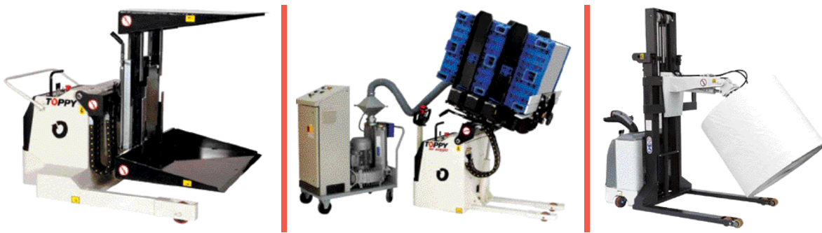
3. ábra: Papírívek és -tekercek mozgatására szolgáló Toppo-berendezések
