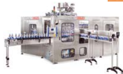
1. kép: Új „Hydra Iso” töltő csendes és szénsavas italokhoz
