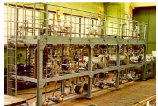
4. kép: A villámgyors beépíthetőség végett moduláris elemekből készült rövid utas filmbepárló
