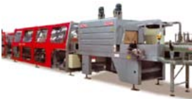
2. kép: „Vega S 50/2” zsugorcsonomagoló
