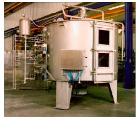
2. kép: Teljesen zárt pasztillázó berendezés a GMF-től különösen toxikus, illetve oxidatív anyagok pasztillázására
