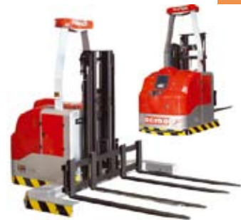
3. kép: „Auriga” Teljesen automata targonca és rakodóegység
