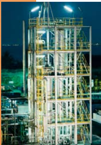
3. kép: Buss-SMS bepárló a szingapúri kikötőben a hajóforgalom miatt bekerülő olajszennyezés elválasztására
