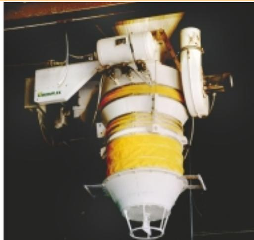
**A** töltőcsövek (4 db) az épületen belül kialakított töltőfolyosóban helyezkednek el. Egy-egy töltőcsőhöz négy funkció tartozik. Mindegyik cső zár és nyit, poros levegőt szív el és szűr meg, leereszti és felhúzza a töltőcsövet, végül, ha kell a forgó szintjelző leállít. A töltőcsövek ventilátorairól tiszta levegő távozik. A töltőcsövek tartozékait, a porszűrőket sűrített levegő tisztítja, így a "filterliszt" visszahullik a tartálykocsiba.
